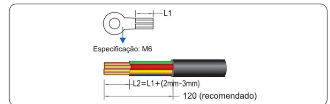
Passo 2 Insira os fios expostos na área de crimpagem do terminal olhal e crimpe utilizando um crimpador. Envolve a área com isolante termo-retrátil ou fita isolante PVC.
