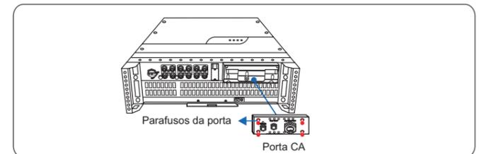
Passo 4 Remova o parafuso da tampa inferior, em seguida puxe a tampa manualmente ou utilizando uma chave de fenda.
