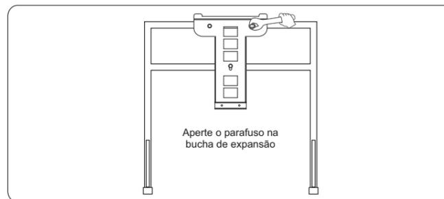
Passo 2 Encaixe e fixe o inversor no suporte de fixação.
