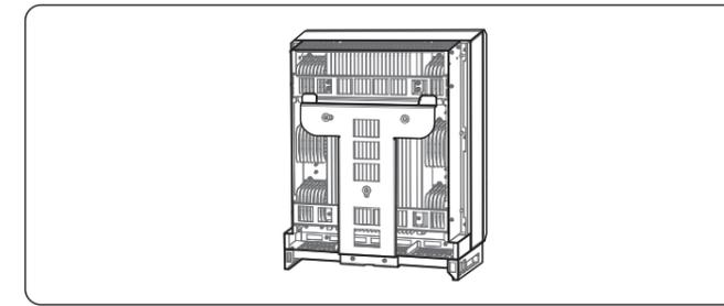
Passo 3 Aperte os parafusos M6 no inversor e suporte.
